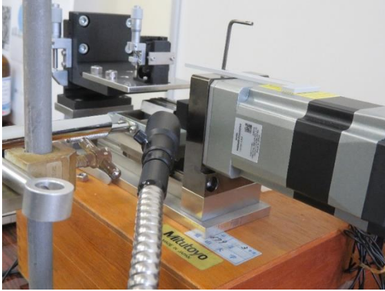
図3 水平押し込み試験機.
