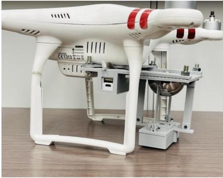
図9 支柱型カメラユニット搭載
