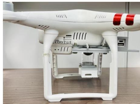
図7 アクリルパイプ型カメラユニット搭載
