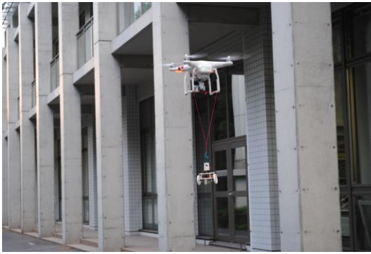
図3 ドローンによるロボット運搬 Fig.3 Robot Transportation using Drone
