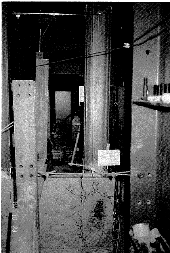
写真-5 柱脚の破壊状況 (No.3-A)
