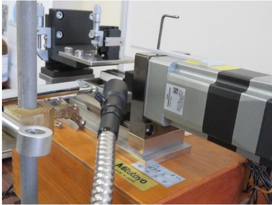
図 4 水平押込み試験機。
