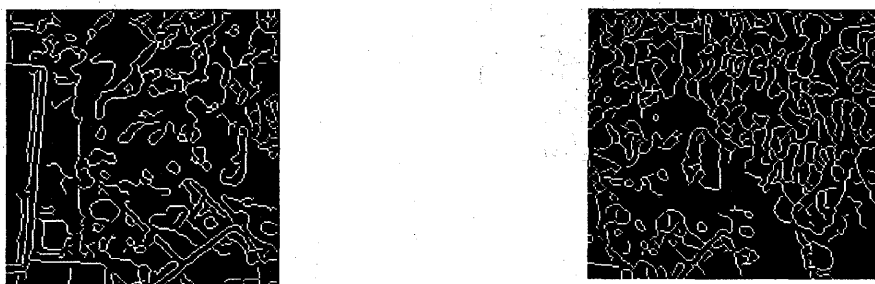
図 5. 図 4 から Canny の方法で検出したエッジ Fig.5. Edges detected from Fig.4 by the Canny's Algorithm
